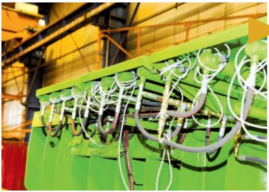
Tables destinées à équiper vos unités de pré-fabrication (murs, panneaux de façade...), ces tables sont soit monoblocs soit à plateau flottant permettant le réglage de la planéité.
